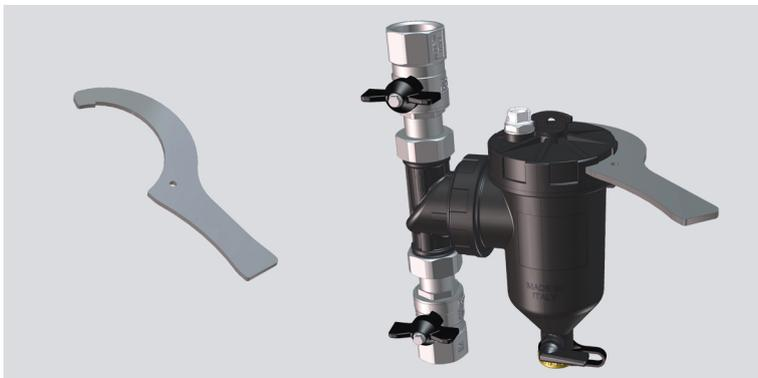
Per ispezionare completamente il defangatore o per pulire o sostituire la cartuccia filtrante è possibile svitare completamente il tappo superiore mediante la chiave di manovra in dotazione.
