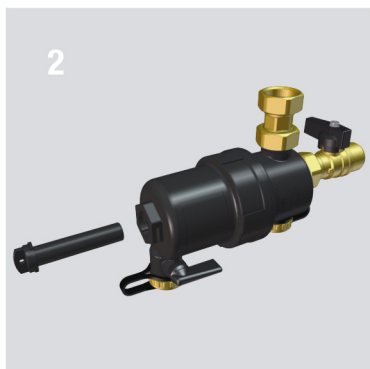
Retrait de l'aimant (tourner de 90° dans le sens des aiguilles d'une montre)
