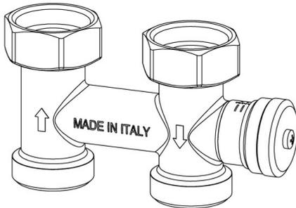
Das Bypass-Set für Primärkreislauf (optional) ermöglicht die hydraulische Entkopplung zwischen dem Primär- und Sekundärkreislauf. Diese hydraulische Entkopplung optimiert den Betrieb des Sekundärkreislaufs und verhindert, dass sich Durchflussänderungen im Primärkreis auf den Sekundärkreis auswirken. Die Durchflussmenge durch die jeweiligen Kreise hängt ausschließlich von den Leistungsmerkmalen der Pumpen ab, wobei die gegenseitige Beeinflussung durch die Serienschaltung vermieden wird.
