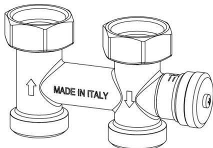
Il by-pass per circuito primario (opzionale) permette la separazione idraulica tra il circuito primario e il secondario. Questa separazione idraulica ottimizza il funzionamento del circuito secondario ed impedisce che modifiche sulla portata del primario influenzino il circuito secondario. La portata che passa attraverso i rispettivi circuiti dipende esclusivamente dalle caratteristiche di portata delle pompe, evitando la reciproca influenza dovuta al loro accoppiamento in serie.
